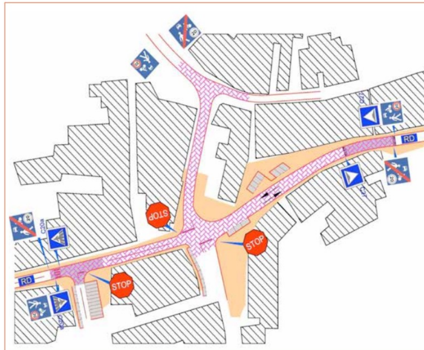
Exemple d'un ensemble de voirie traité en zone de rencontre prévoyant un changement de revêtement de la chaussée
