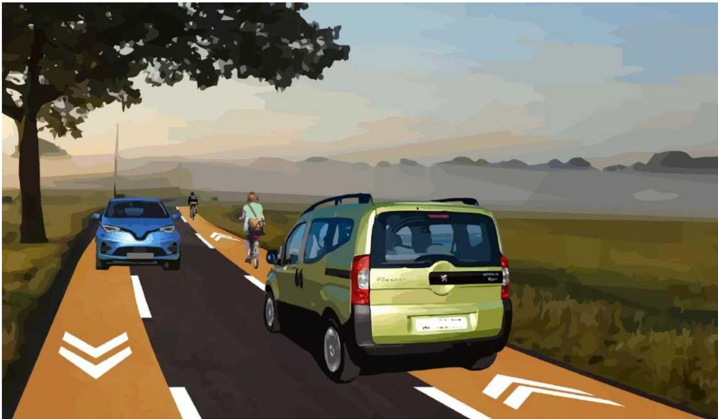
La CVCB est une chaussée étroite sans marquage axial dont les lignes de rive sont rapprochées de son axe. Les véhicules motorisés circulent **sur une voie centrale bidirectionnelle** et les cyclistes sur la partie revêtue de l'accotement appelée **rive**.
